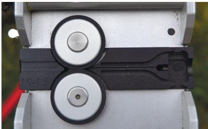
Для микрокабелей размером 3,0 – 4,5 мм применяется переходные пластины NanoFlow MAX и стальное колесо MAX.
